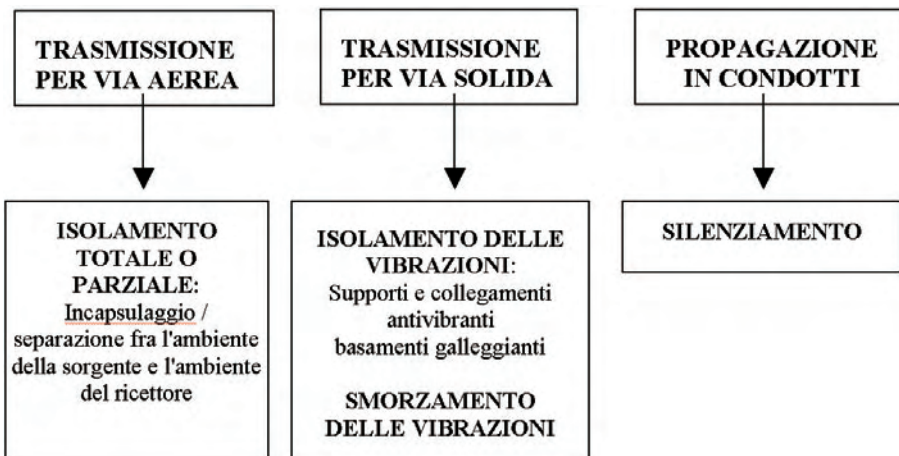
Figura 6.5: Tecniche di controllo della trasmissione sonora.
